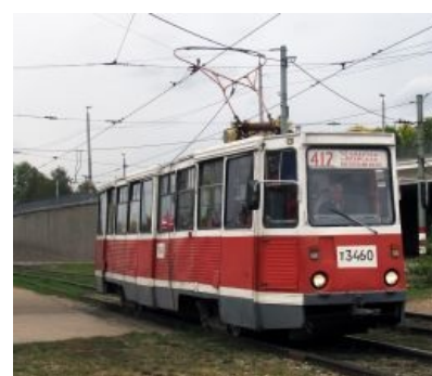
КТМ-5 в Нижнем Новгороде. 417 маршрут (спойлер: результат объединения 4 и 17 маршрутов) и бугель вместо пантографа
