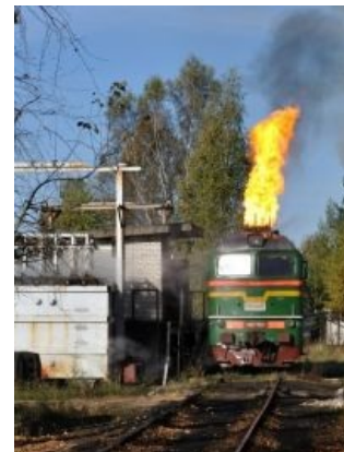
Тепловоз на реостатных испытаниях
