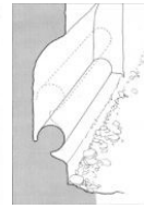
Способ добычи колонн в древнеримской каменоломне Чемту, Тунис
