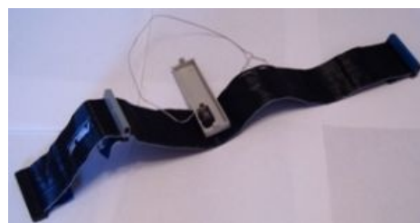
Модифицированный IDE-шлейф для «горячего» выключения IDE-приводов
