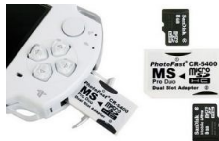
Вариант получения MemoryStick-а на 16Gb из двух MicroSD по 8 Gb.
