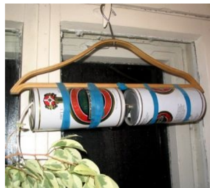
Испив пивка, радиолюбитель-конструктор с бодуна может соорудить такой вот широкополосный полуволновый вибратор на УКВ
