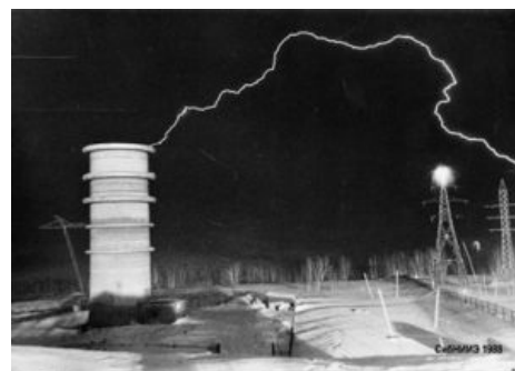
ГИН, ловко маскирующийся под Tesla Coil Новосибирск , стенд СибНИИЭ
