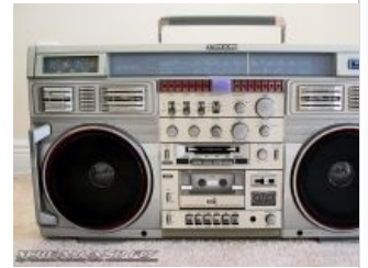
Эталонный геттоблэстер CONION C-100F, размеры 78×41×20, выходная мощность 40W RMS, засветился во многих фильмах 80-х
