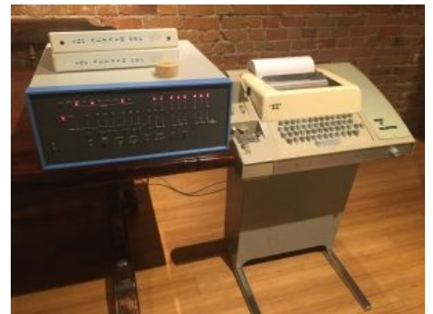
Отдалённый потомок швейной машинки Зингера Altair 8800. Первый массовый компьютер с отупляющим действием Бейсика.
