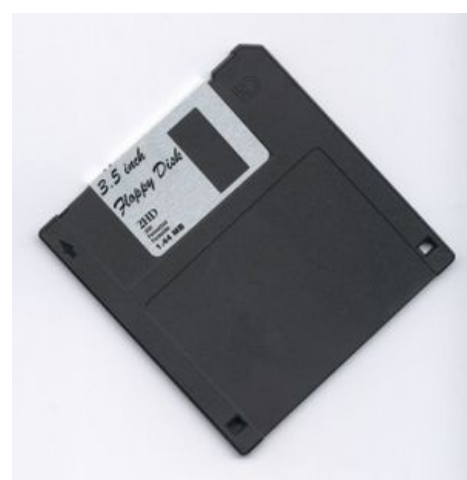
Дискета 3,5", как ни странно, не круглая внешне. Но внутри — круглый гибкий магнитный диск
